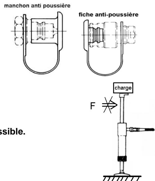
Aucune charge latérale exercée sur le piston n'est pas admissible.
